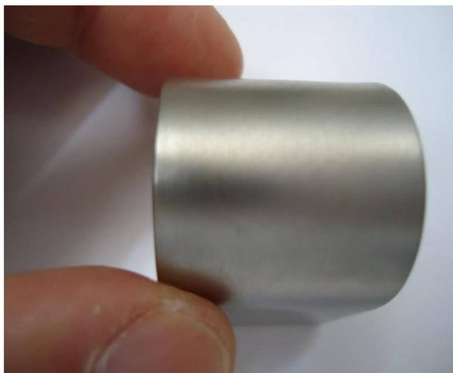
**Figura 27** – Corpo de prova de corrosão intergranular após o dobramento
