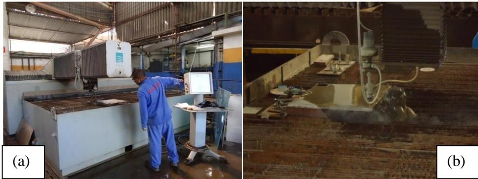
**Figura 10** – Corte com jato d'água: (a) máquina de corte; (b) máquina de corte mais detalhada
