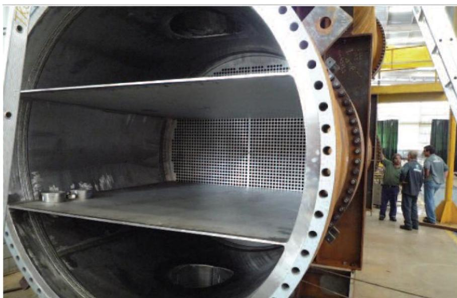
**Figura 4** – Trocador de calor construído com aço ao carbono revestido com aço inoxidável super duplex. Adaptado de [19].
