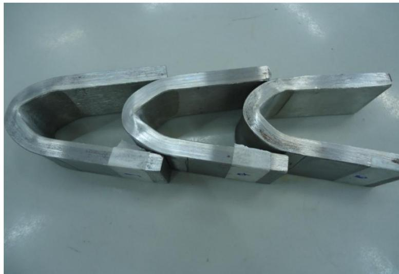
**Figura 26** – Corpos de prova dobrados até 180°
