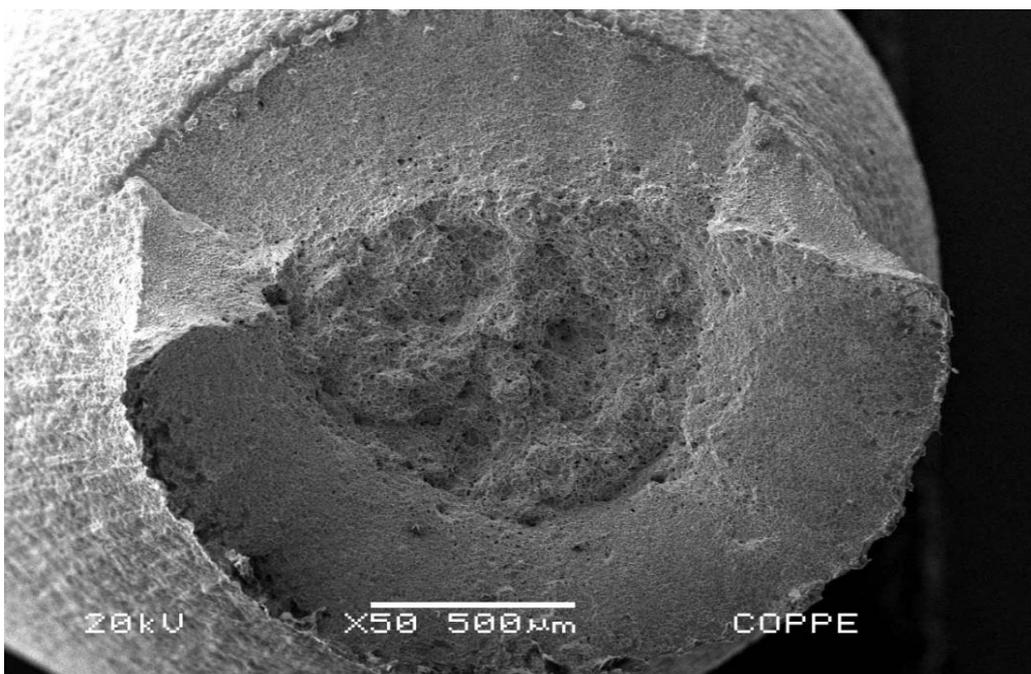
**Figura 22 - Aço duplex S32760 – aspecto geral da superfície de fratura ao ar – Aumento 50X**
