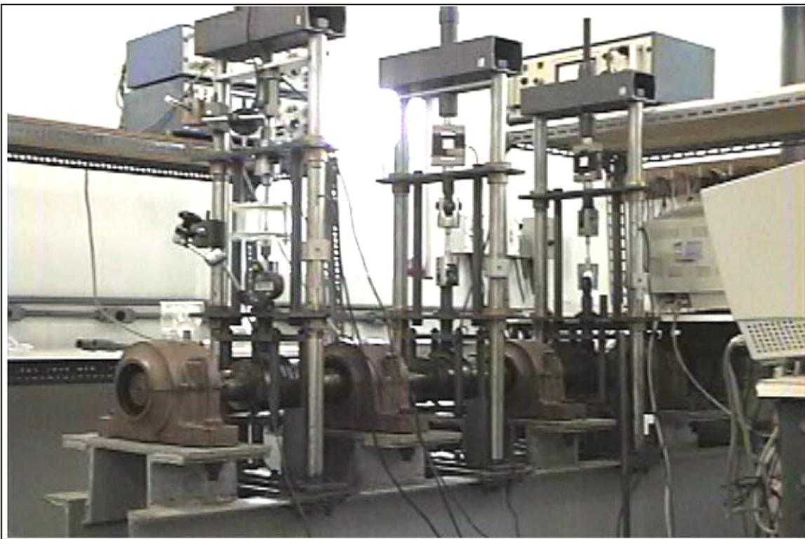
**Figura 6: Máquina de tração utilizado nos ensaios BTM.**
