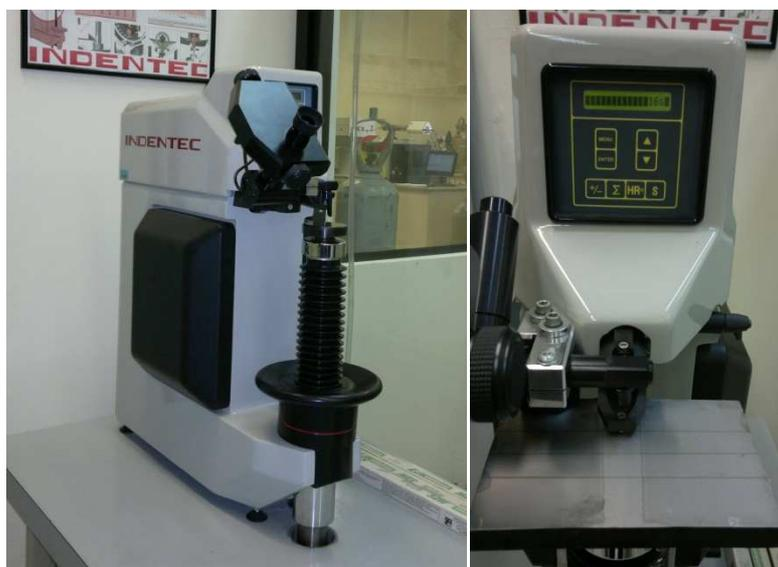
**Figura 16** – Máquina para o ensaio de dureza, a qual se encontra no Laboratório de Propriedades Mecânicas no PEMM/COPPE-UFRJ.
