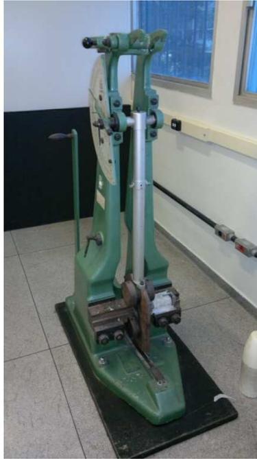
**Figura 27** – Máquina de ensaio de impacto Charpy a qual se encontra no laboratório de aulas práticas e metalografia no PEMM/COPPE-UFRJ.
