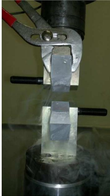
**Figura 23** – Imagem logo após a fratura total de um dos corpos de provas C(T) do MB.
