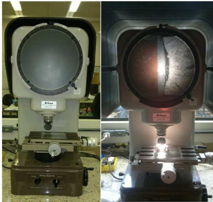
**Figura 25** – Projetor de perfis, o qual se encontra no Laboratório de Propriedades Mecânicas no PEMM/COPPE-UFRJ.
