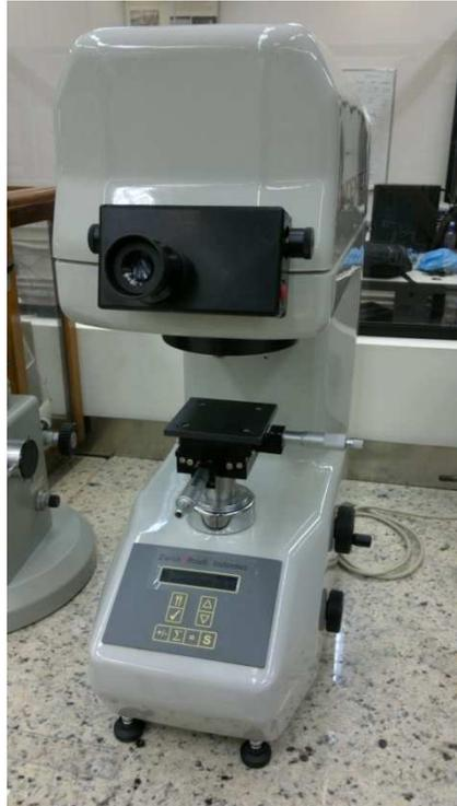
**Figura 17** – Máquina para o ensaio de microdureza, a qual se encontra no Laboratório de Propriedades Mecânicas no PEMM/COPPE-UFRJ.
