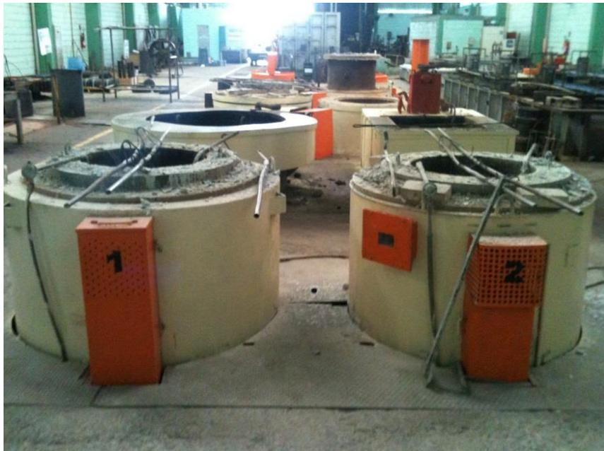
Figura 13 – Fornos com banho de sal aquecidos por resistência elétrica.
