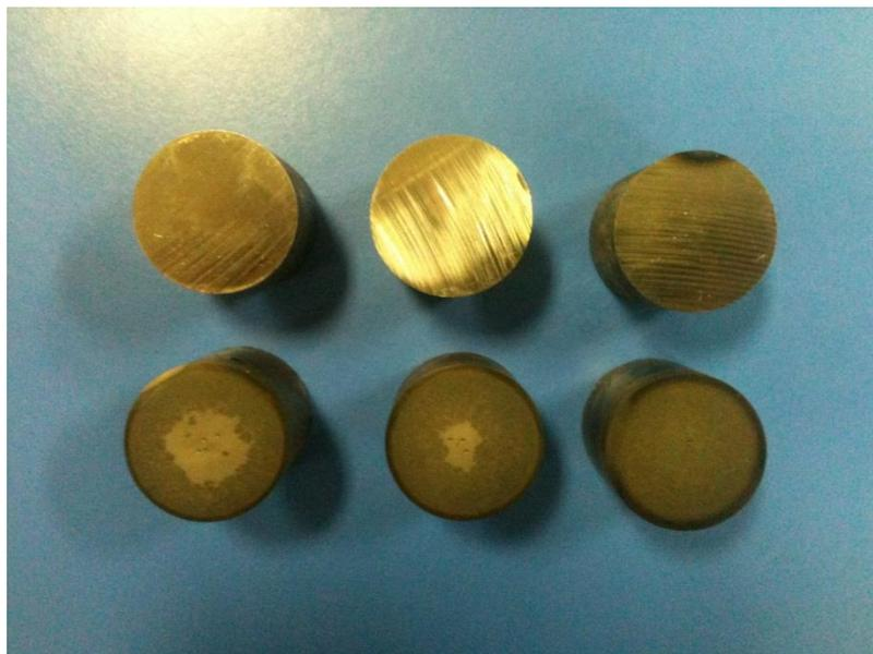
Figura 23 - Corpos de prova atacados com nital 2%.
