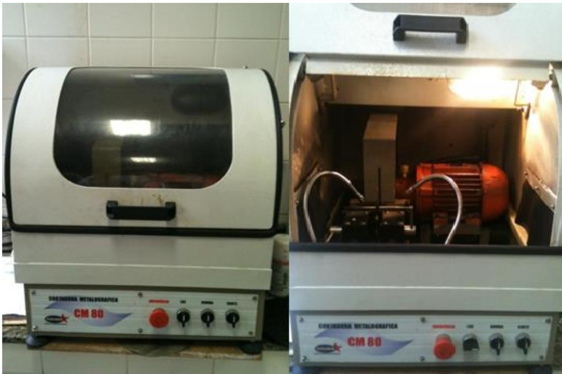
Figura 18 - Cortadora metalográfica TECLAGO CM 80 interior e exterior.
