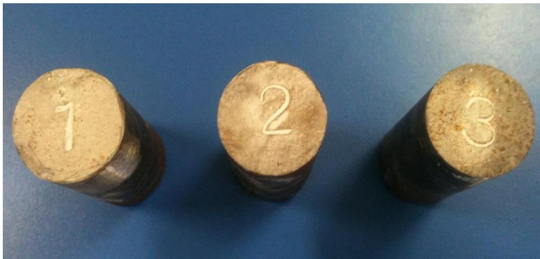
Figura 11 - Corpos de prova cementados e temperados em banho de sal com aquecimento por resistência elétrica.
