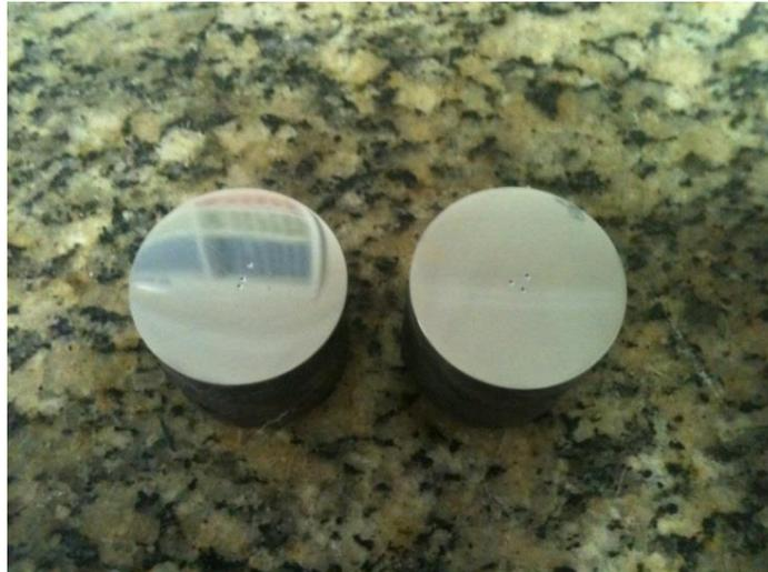
Figura 20 - Corpos de prova com a superfície polida.
