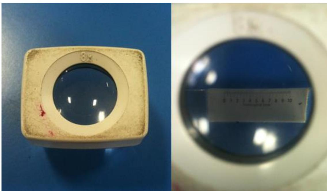
Figura 22 - Lupa utilizada para a medição da camada visual cementada.
