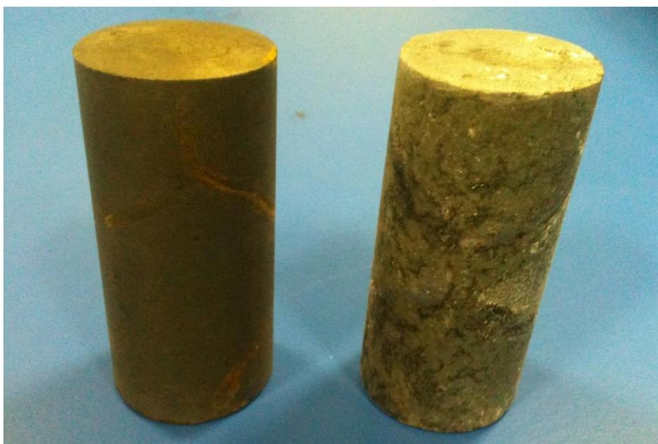
Figura 12 - Corpos de prova tratados no forno T4 e banho de sal
