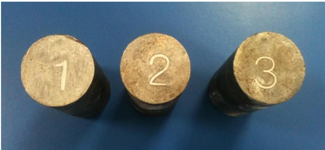
Figura 10 - Corpos de prova cementados e temperados em banho de sal com aquecimento a gás.
