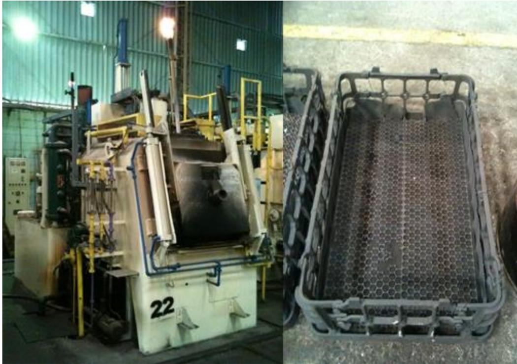
Figura 16 - Forno T4 (cementação em meio gasoso)
