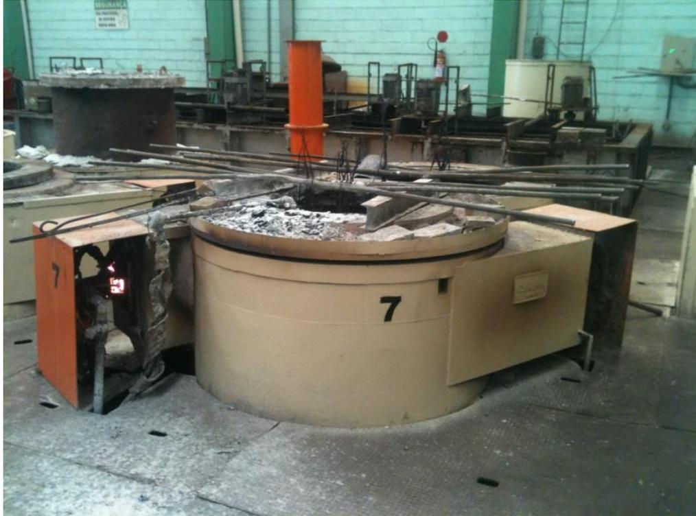
Figura 15 - Forno com banho de sal aquecido por gás (GNV).
