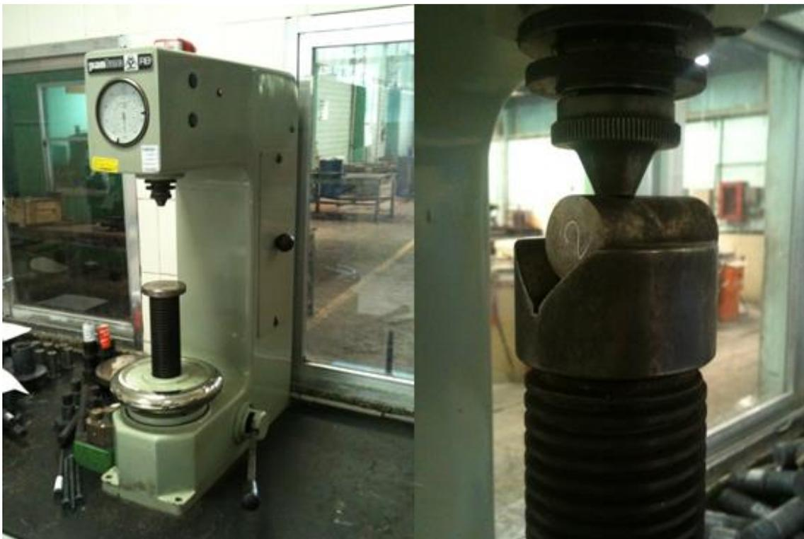
Figura 17 - Durômetro de bancada e corpo de prova sendo submetido ao ensaio de dureza (Rockwell C).
