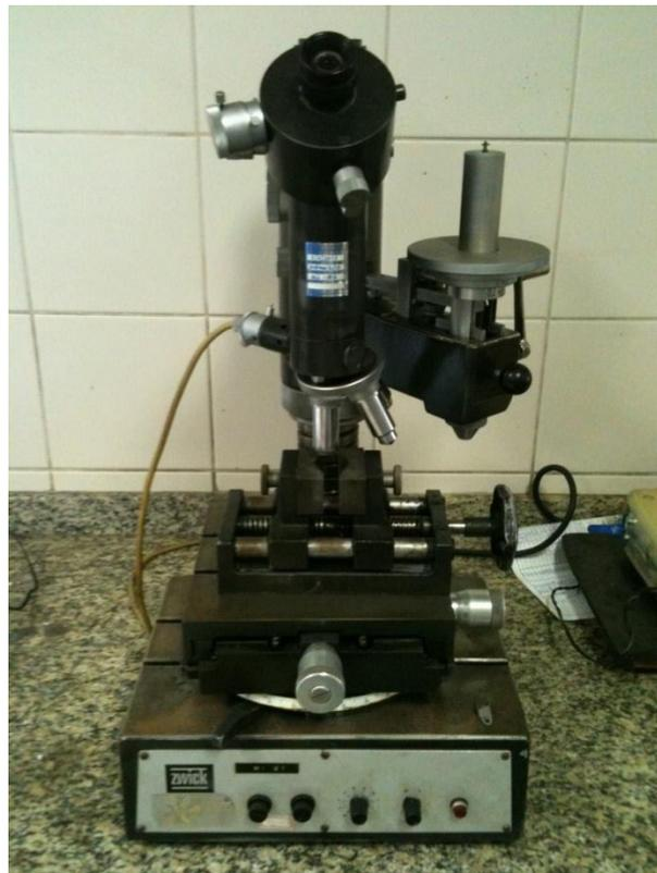
Figura 21 - Microdurômetro utilizado no ensaio de camada efetiva.
