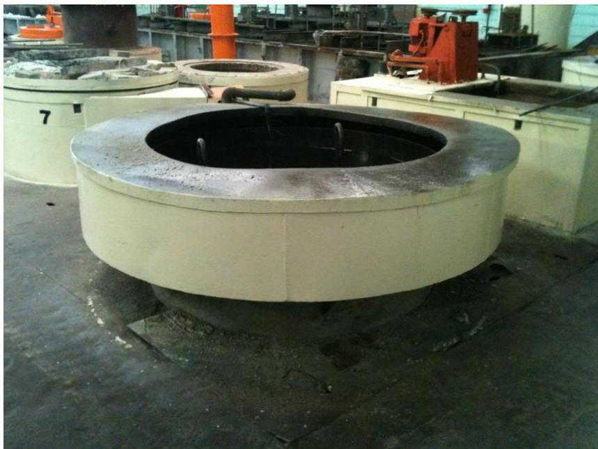
Figura 14 - Tanque de resfriamento para têmpera em óleo.
