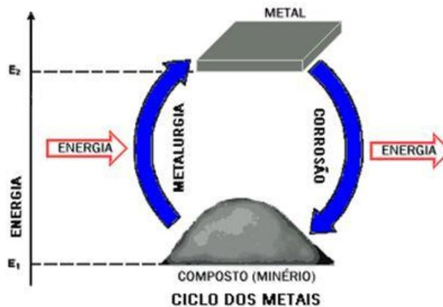
Figura 19: Processo de corrosão em metais [3].
