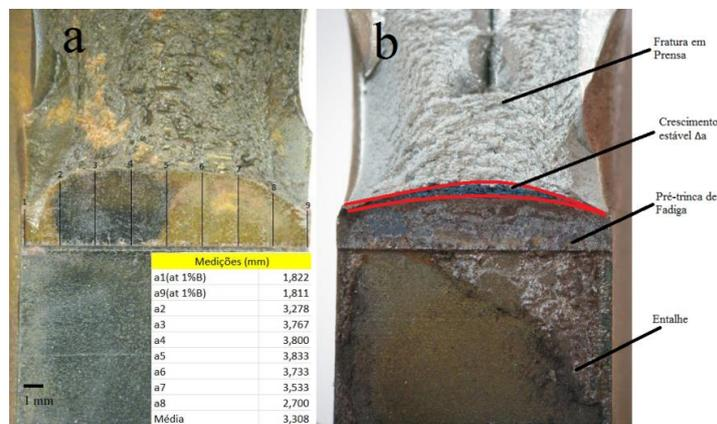
**Figura 41:** (a) Esquema de medição da pré-trinca de fadiga (b) Diferentes regiões da superfície de fratura após ensaio
