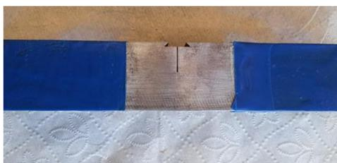
**Figura 45:** Corpo de prova pintado com tinta isolante para confinar a área de evolução de hidrogênio nas proximidades da pré-trinca
