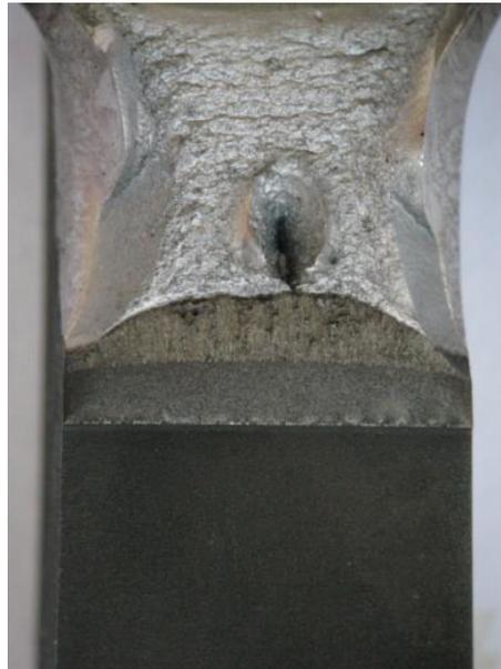
**Figura 58:** Fractografia do CP2 - MB hidrogenado por estereoscópio.
