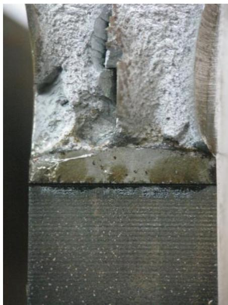
**Figura 70:** Fractografia do CP4 – X80LH hidrogenado por estereoscópio
