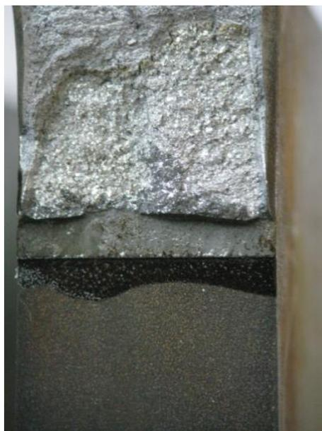
**Figura 64:** Fractografia do CP3 – X80HH hidrogenado por estereoscópio.
