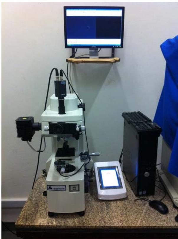
Figura 32 – Microdurômetro Vickers utilizado no ensaio de dureza.
