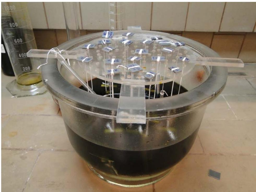
Figura 35 – Arranjo utilizado no ensaio ASTM G48.
