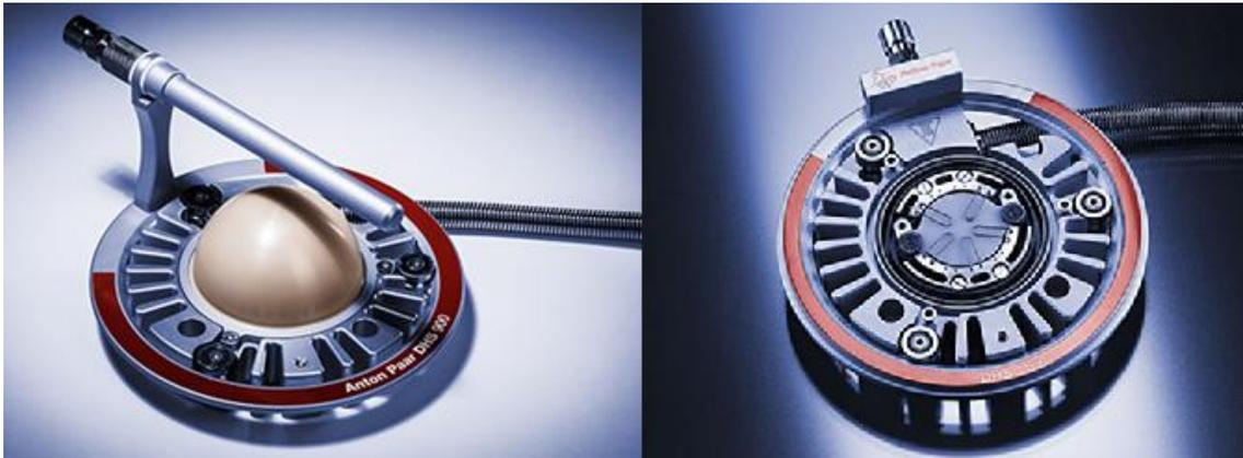
Figura 15: Forno acoplado ao difratômetro de raios-x.
