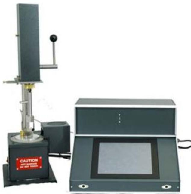
Figura 9 - Plastômetro gieseler. Retirado de [20].
