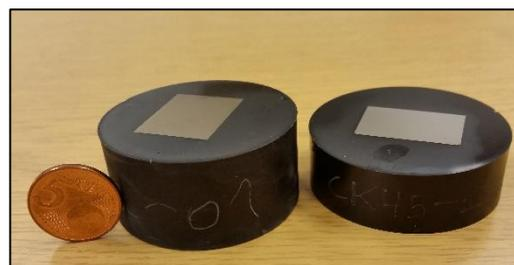
Figura 4.2.2: Amostras cortadas e embutidas.
