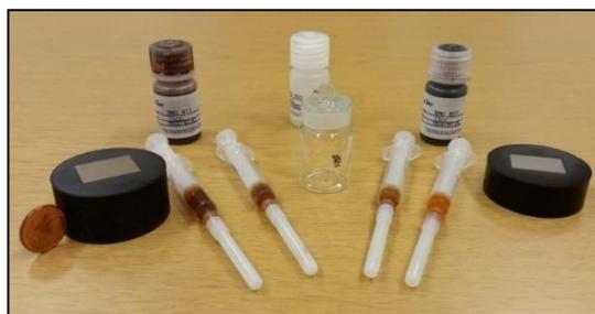
Figura 4.4.2: Materiais utilizados para aplicação do ferrofluido.
