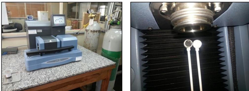
**Figura 10:** Equipamento TGA à esquerda e haste com material para ensaio à direita.
