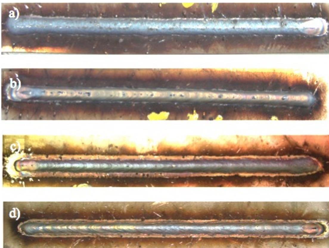
Figura 22: Resultado dos cordões soldados sobre chapa a) sem uso do trailing gas; b) utilizando trailing gas ArH-10; c) utilizado trailing gas NH-10 e d) utilizando trailing gas ArH-15.
