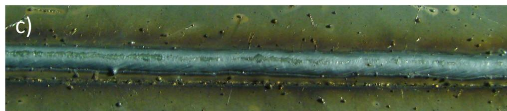
*Figura 26: a) Passe de raiz, b) passe de enchimento e c) passe de acabamento*
