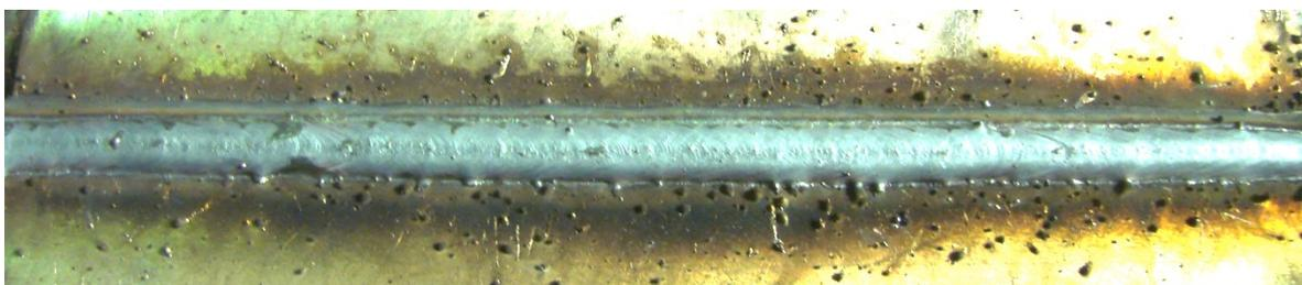
Figura 24: Corpo de prova soldado sem resfriamento até temperatura ambiente entre os passes.
