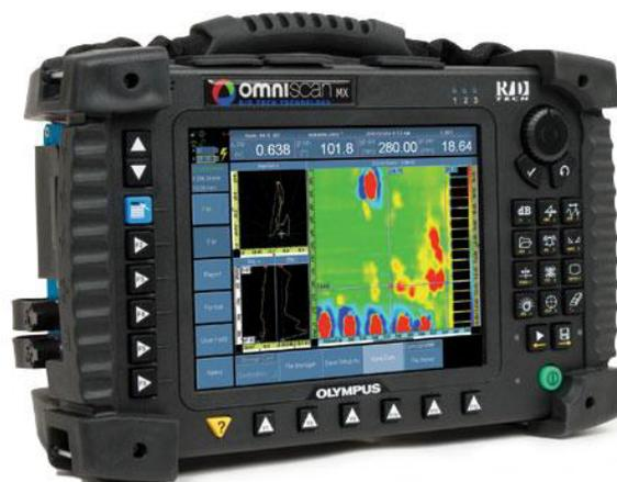
**Figura 3.4 – Equipamento de correntes parasitas utilizado: OmniScan MX ECA da Olympus.**
