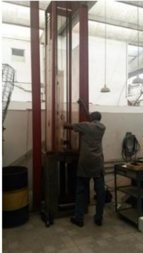
Figura 4. 10 - Célula de carga de impacto para ensaio de DWT
