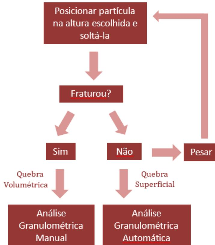
Figura 4. 6 – Fluxograma do ensaio de Autofratura
