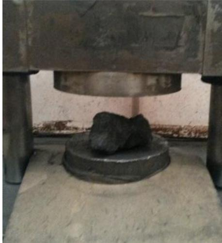
**Figura 4. 9 - Partícula de 63x50mm posicionada para o Teste de Queda de Peso (LTM COPPE UFRJ)**
