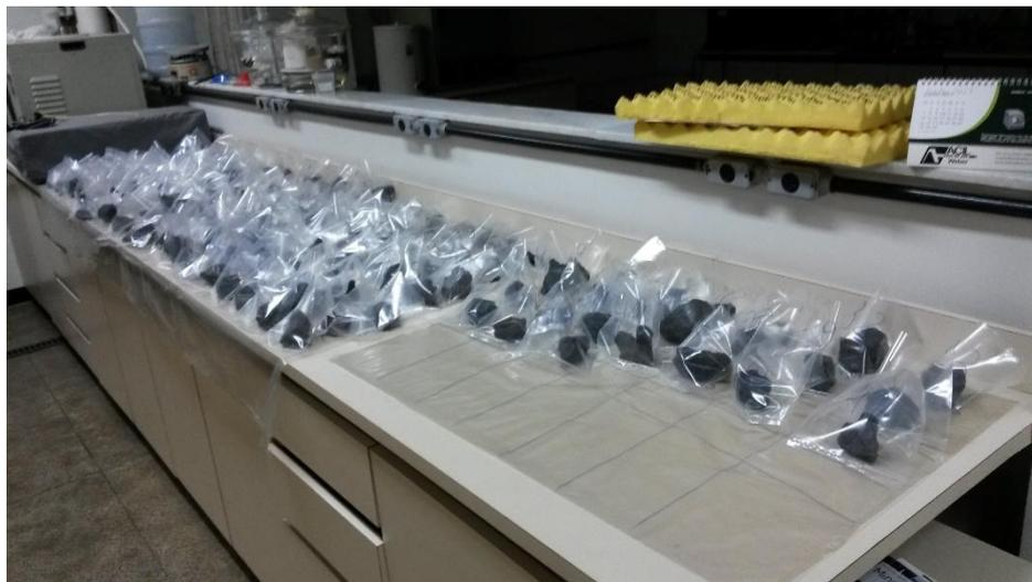
Figura 4. 7 - Amostras individuais de partículas de tamanho 63x50 mm separadas para ensaio de autofratura
