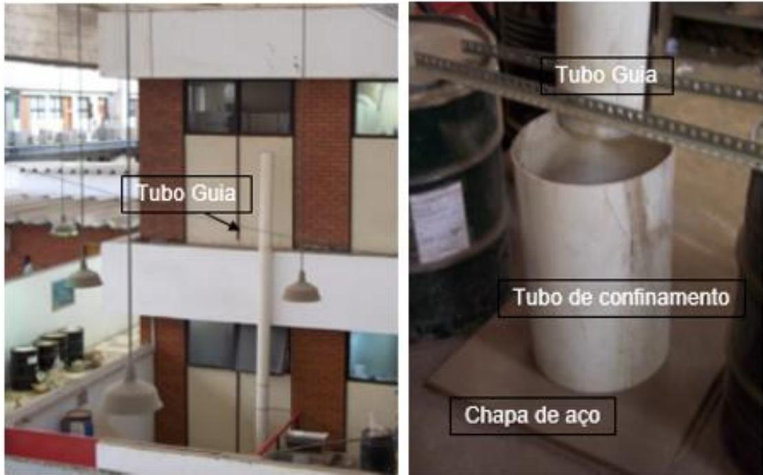
Figura 4. 4 - Foto do aparato de autofratura montado no LTM. À direita o tubo de confinamento, chapa de impacto e tubo guia
