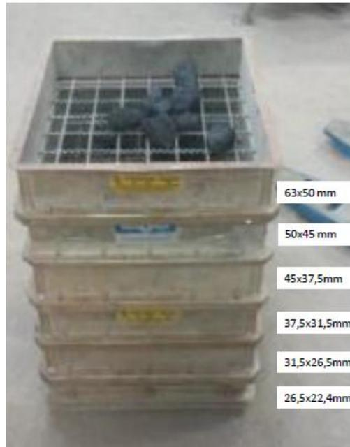
**Figura 4.1 - Série de peneiras padrão Produtest® utilizadas na análise granulométrica dos coques utilizados nesse trabalho**
