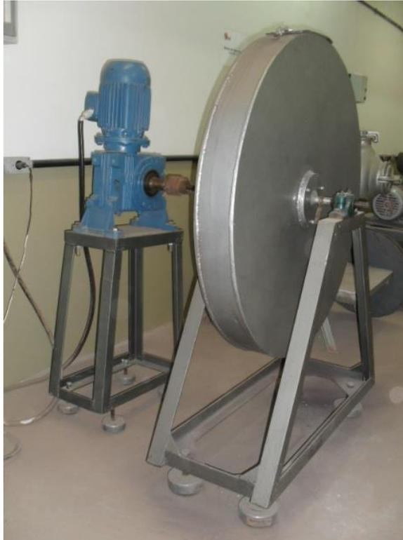
**Figura 4. 8 - Tambor de abrasão utilizado para simular 20 quedas sucessivas de equivalentes a 1 metro de altura**
