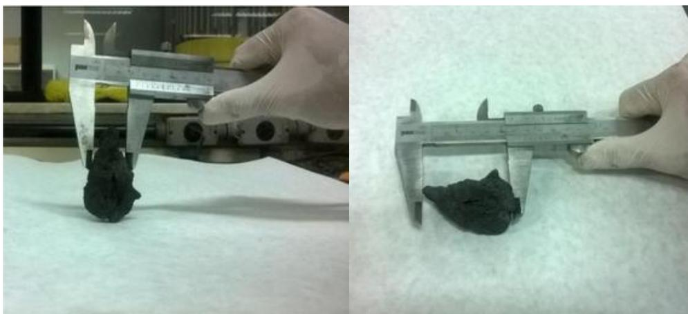
**Figura 4.2 - Medição da menor dimensão (esquerda) e maior dimensão (direita) da partícula com paquímetro**
