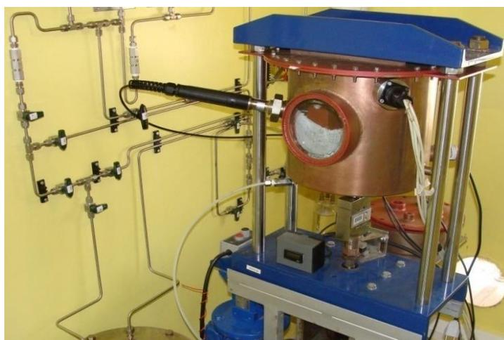
Figura 25 - Cuba para ensaio de envelhecimento acelerado do LAMEF
