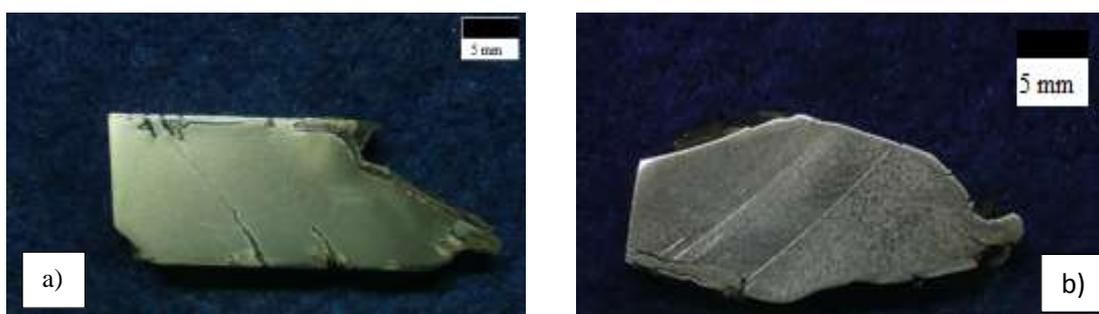
Figura 17- Amostras processadas com invólucro de chapa (a) material com 1 passe (b) material com 2 passes.
