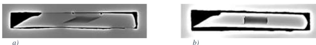
Figura 16 - Radiografias das pastilhas processadas com invólucro de aço baixo carbono (a) material com 1 passe (b) material com 2 passes.
