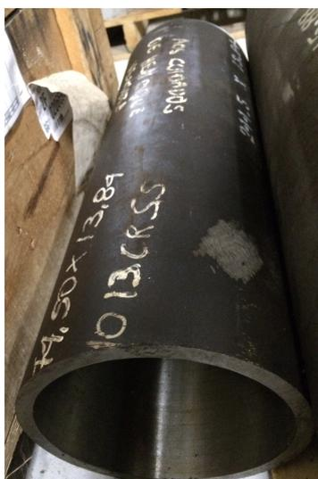
Figura 22: Tubo do aço Super 13Cr utilizado no trabalho.
