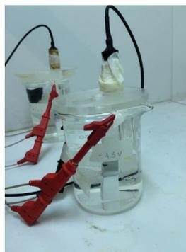
**Figura 25:** Foto panorâmica dos corpos de flexão hidrogenando.
