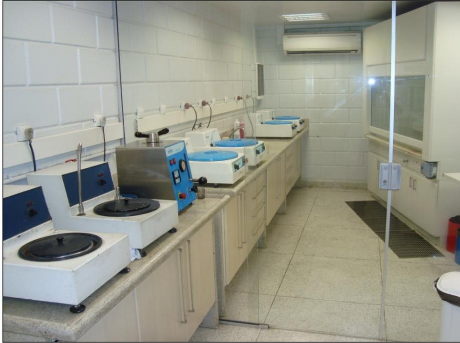
**Figura 3.2.3** – Equipamentos de preparação metalográfica (lixamento e polimento).
