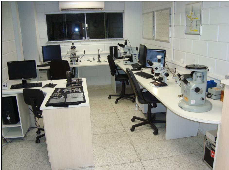
**Figura 3.2.4** – Equipamentos de análise microestrutural (microscopia ótica).
