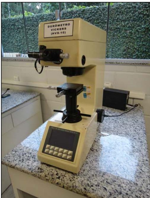
**Figura 3.2.9** – Equipamentos de ensaio dureza Vickers
