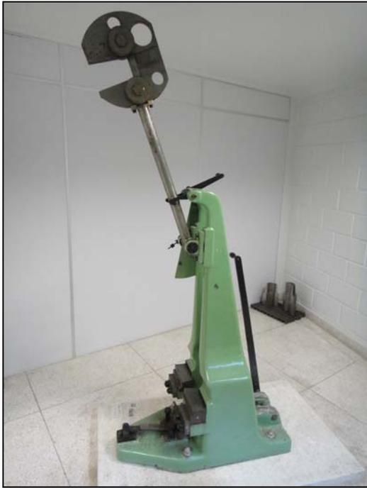
**Figura 3.2.8** – Equipamentos de ensaio Charpy V.
