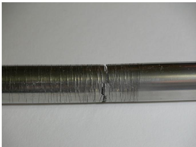
Figura 6.21: Imagem do tubo ensaiado em tração uniaxial logo após o ensaio de hidrogenação sob tensão com corrente de 1 A.
