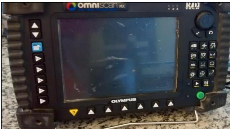
Figura III.2.3.2: Aparelho para interpretar o sinal das correstes parasitas utilizado: Omniscan MX ECA da Olympus.
