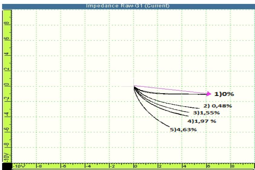
Figura IV. 2.1: Ensaio de corrente parasita com sonda de caracterização.
