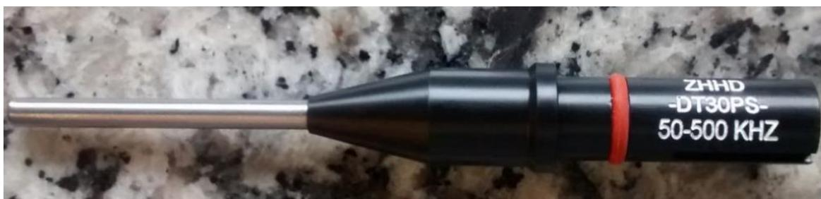
Figura III.2.4.1: Sonda de detecção de defeitos ZETEC DT 30 PS.
