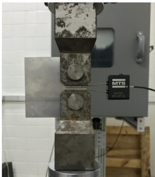
**Figura 26:** Montagem do ensaio com corpo de prova inserido no equipamento.
