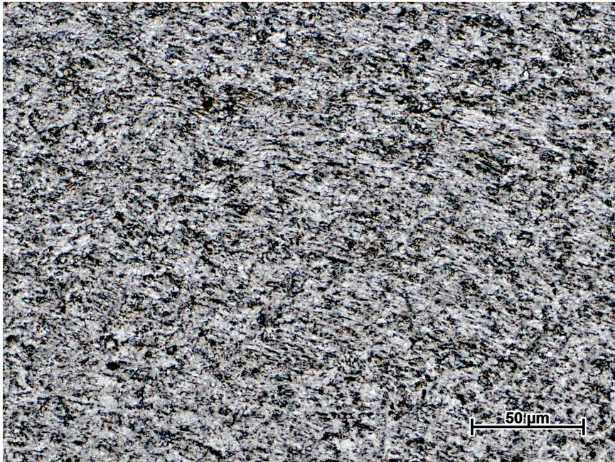
**Figura 32:** Micrografia da ZTA da solda circunferencial com aumento de 500x em sentido longitudinal ao crescimento de trinca.
