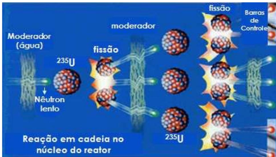
Figura 2: Reação em cadeia dentro do núcleo de um reator (retirado de [6]).
