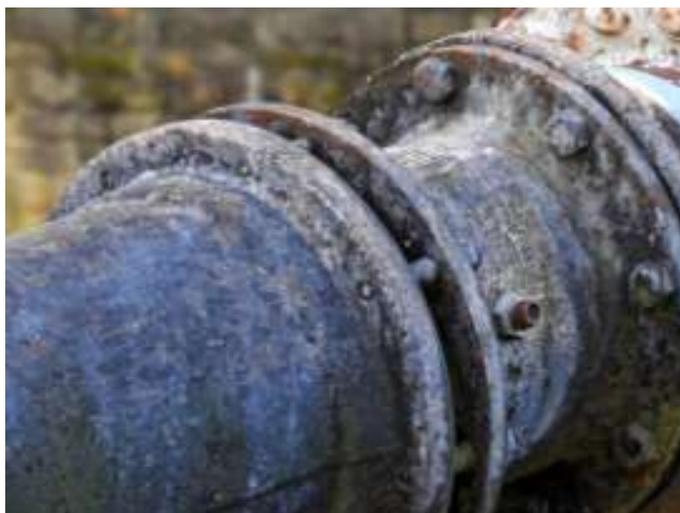
Figura 20: Exemplo de um componente com marcas características de empolamento pelo hidrogênio (retirado de [42]).
