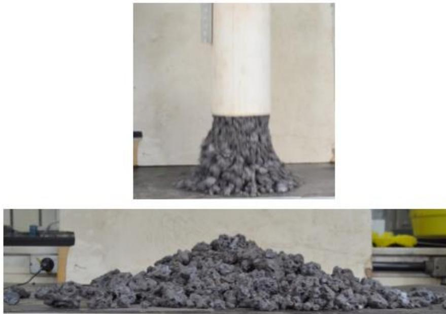
Figura III.5: Ensaio de ângulo de repouso, com partículas de sinter (Lima, 2016)
