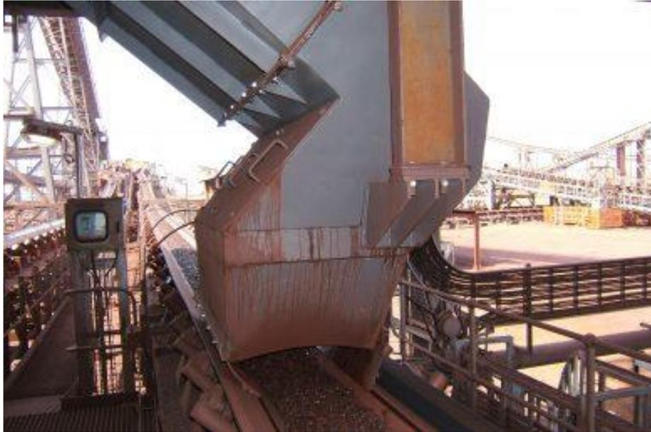
Figura III.11: Sistema de chute de transferência com correia de projeção (*International Mining*, 2014)
