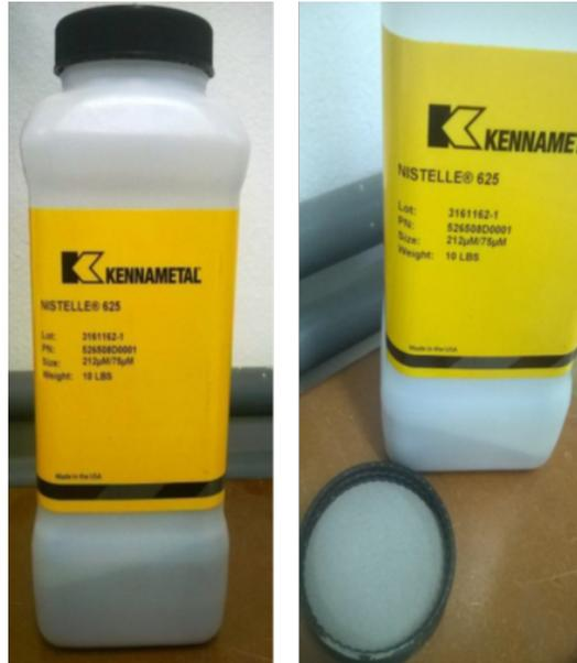
*Figura 19: Metal de adição Superliga de Níquel 625 em pó.*
