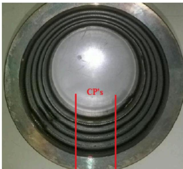
Figura 22: Corte transversal para a retirada da amostra para análise
