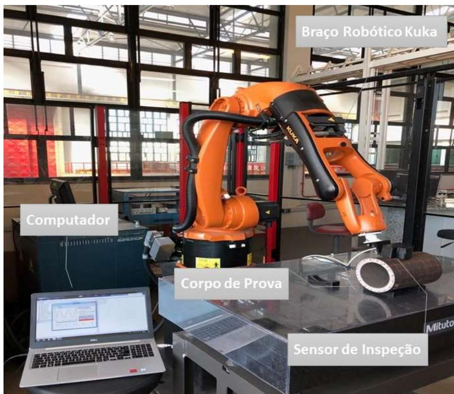
**Figura 14** - Arquitetura do Sistema de Inspeção. Em destaque o Braço Robótico Kuka, Computador, Corpo de Prova e Sensor de Correntes Parasitas.
