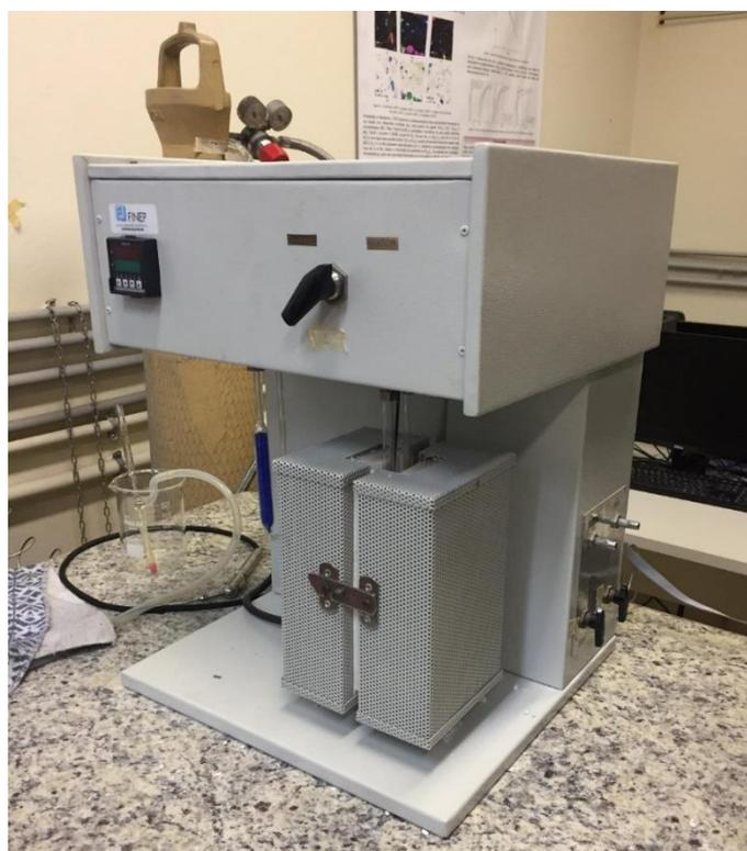
*Figura 9 - Sistema do ensaio de TPR*
