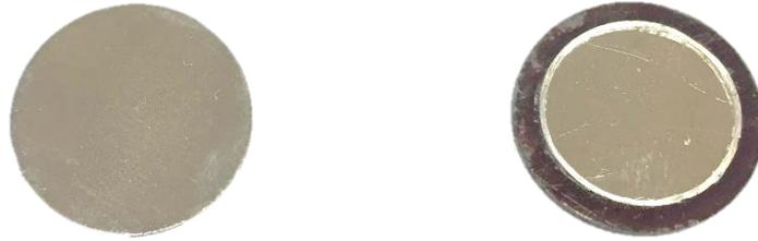
*Figura 7 - Corpos de prova de permeação. À esquerda, o corpo de prova preparado para o ensaio. À direita, o corpo de prova pós ensaio de permeação.*
