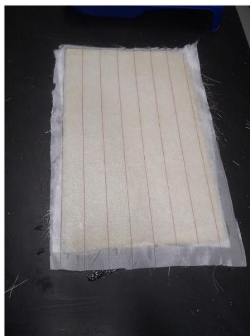
**Figura 11:** Placa do compósito produzido.
