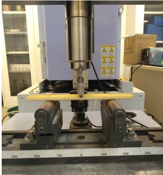
**Figura 15:** Montagem do ensaio de flexão.
