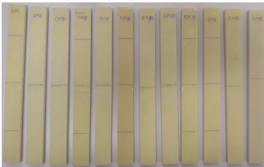
**Figura 13:** Corpos-de-prova de flexão cortados.
