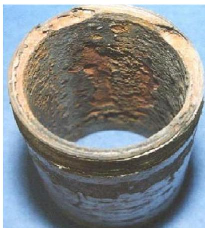
Figure 10 – Corrosão em tubo, adaptado de [21]
