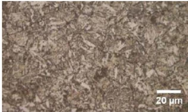
Figura 7 – Microestrutura Martensítica Revenida, adaptado de [19]
