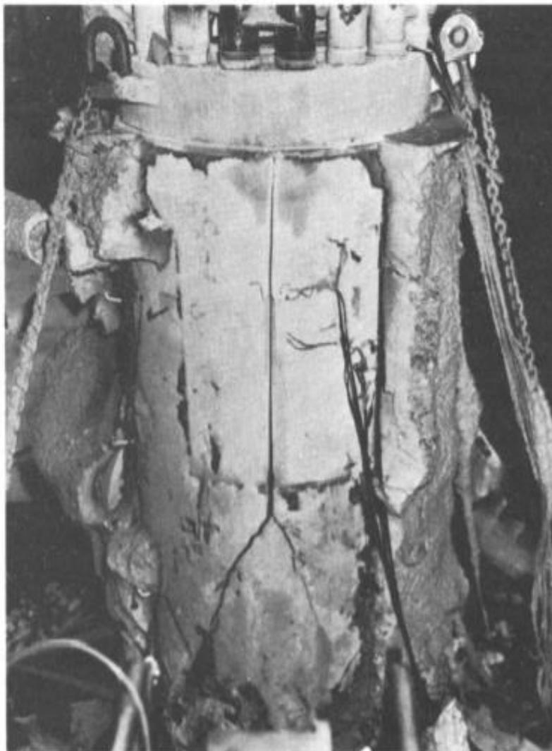
*Fig. 19 - Vaso de pressão de reator no instante após a falha [16]*
