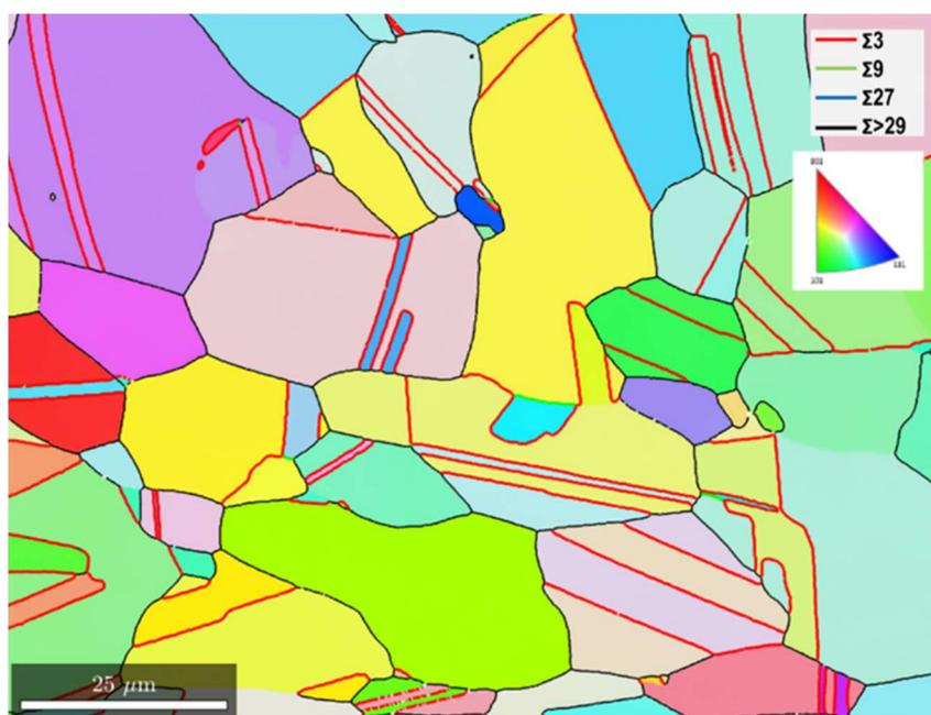
Figura 57 – Figura de polo inversa (FPI) e o mapa de orientação dos grãos da amostra SOL-DE com mapa de contornos de grão mostrando os contornos RHAB em preto,  $\Sigma 3$  em vermelho,  $\Sigma 9$  em verde claro e  $\Sigma 27$  em azul, para a amostra SOL-DE.
