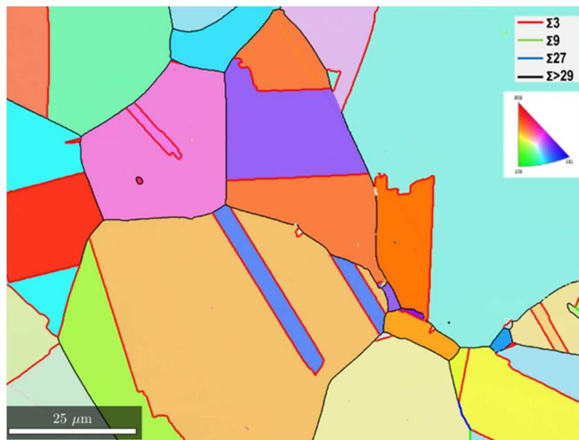
Figura 60 – FPI e o mapa de orientação dos grãos da amostra RB-DE com mapa de contornos de grão mostrando os contornos RHAB em preto,  $\Sigma 3$  em vermelho,  $\Sigma 9$  em verde claro e  $\Sigma 27$  em azul.
