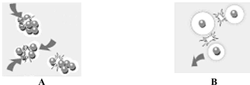
Figura 2.10: a) formação dos aglomerados de partículas resultantes das colisões entre elas na ausência de forças repulsivas; b) partículas dispersas e defloculadas [60]
