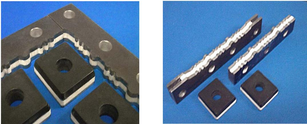
Figura 2.4: Machos e molduras de boquilhas e telhars da DNCER
