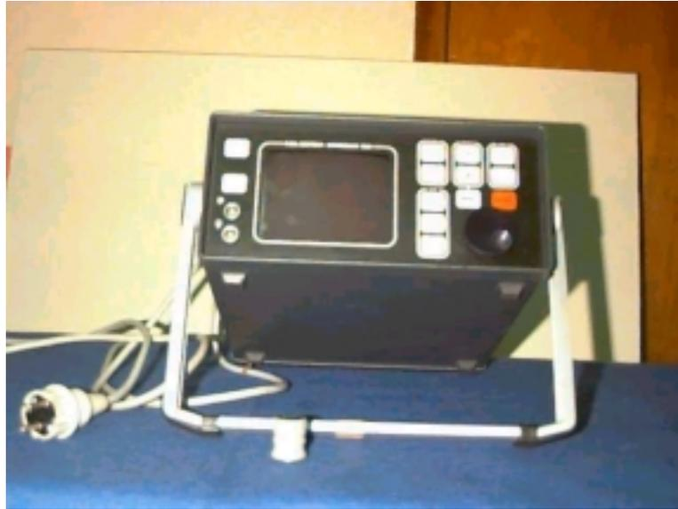
Figura III.4. Aparelho de ultra-som Echograph 1080.
