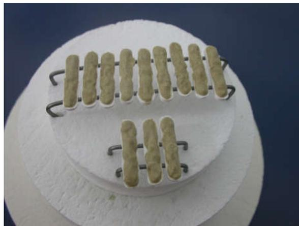
Figura 22: Barras de alumina com vidro de lantânio, antes da infiltração
