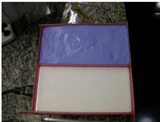
Figura 11: Gesso escaiola e gesso *Sprint* após vazamento sobre placa de vidro
