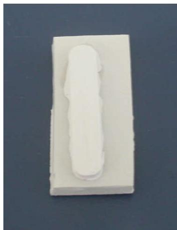
Figura 19: Barra de alumina sobre placa de gesso após extração do padrão de aço inoxidável com extrator de teflon
