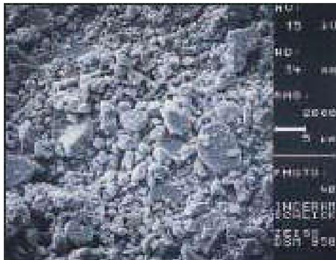
Fig.7 – Morfologia dos pós de alumina utilizados na confecção da subestrutura pelo sistema In-Ceram Alumina [27].
