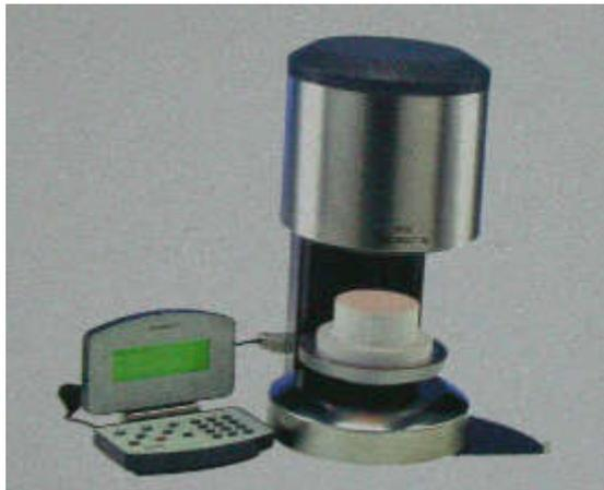
Figura 2: Forno utilizado para sinterização [27].
