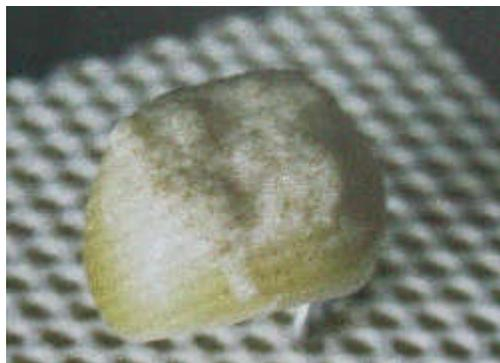
Figura 3: Infiltração de vidro de lantânio [27].
