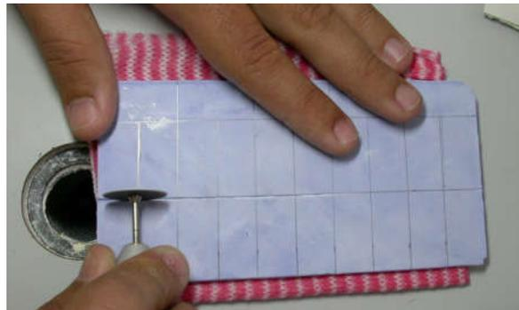
Figura 13: Recorte das placas de gesso com disco de carborundum
