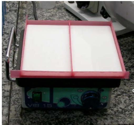
Figura 10: Placa de vidro com dique em cera sobre vibrador
