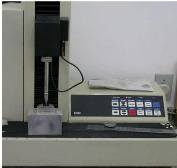
Figura 24: Equipamento EMIC MF 500 para ensaio mecânico
