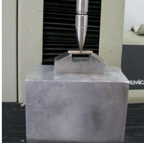
Figura 25: Ensaio mecânico de flexão em três pontos
