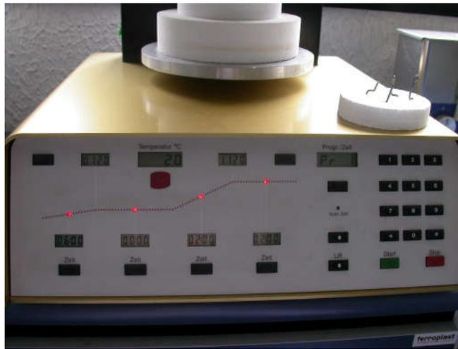
Figura 20: Forno *Inceramat II* indicando ciclo para sinterização da técnica *In-Ceram Alumina*
