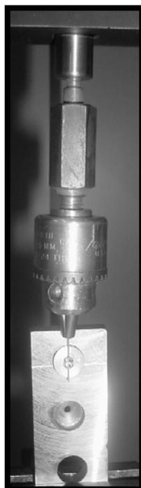
**Figura 12 - Placa com cilindro giratório onde é colado o braquete.**
