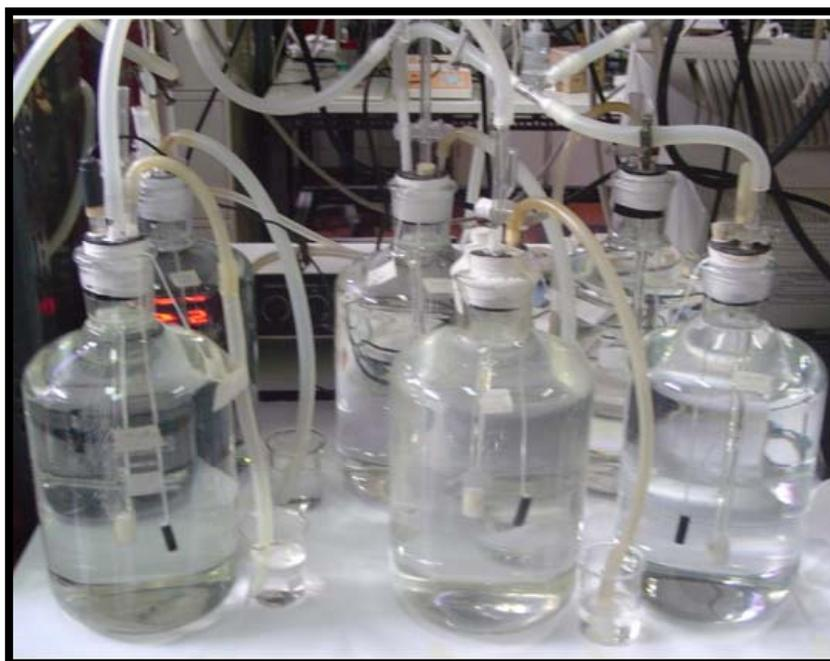
Figura 6: fotografia do experimento montado para o ensaio de perda de massa
