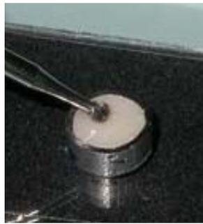
**Figura 10. Remoção do pó da superfície do compósito**
