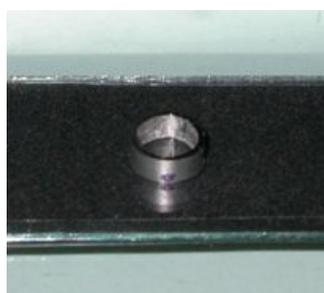
**Figura 5. Matriz metálica sobre a lâmina de vidro**
