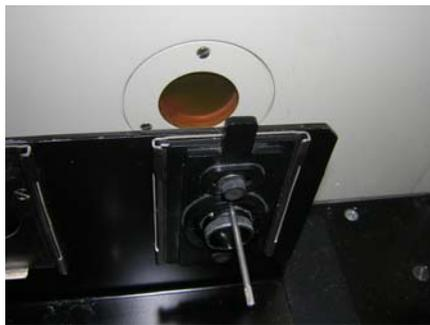
**Figura 15. Suporte + pastilha no Espectrofotômetro**
