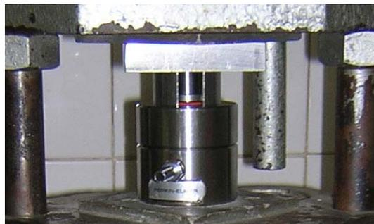
**Figura 13. Pastilhador colocado na prensa**
