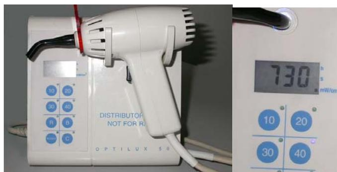
**Figura 7. Unidade Fotoemissora e radiômetro**
