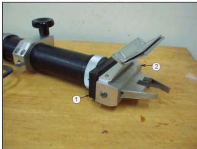
Figura 34 - Colimador de raios-x para medição de tensões na austenita:
