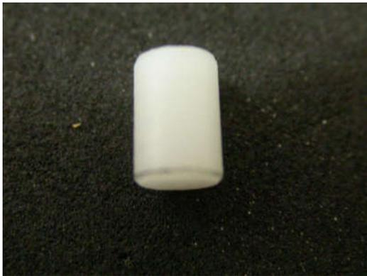
Figura 4.7 Cilindro plástico com dimensões de 6mm de altura e 4mm de diâmetro.
