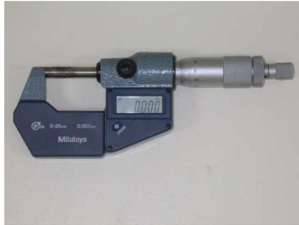
Figura 4.4 Micrômetro Mitutoyo (Digimatic Micrometer) - acuidade de 1 micrômetro.
