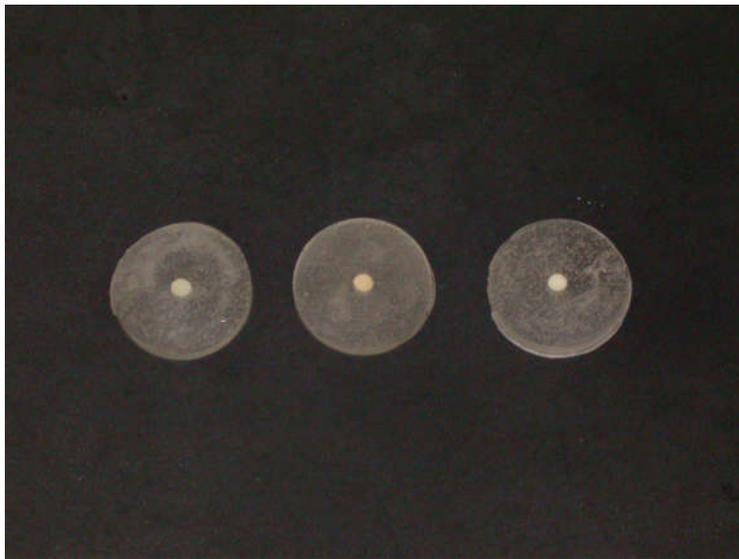
Figura 4.2 Matrizes acrílicas preenchidas respectivamente com os cimentos Ketack Cem, Fuji Plus e Vitremer, curados; lixadas e polidas para análise micrográfica ótica.
