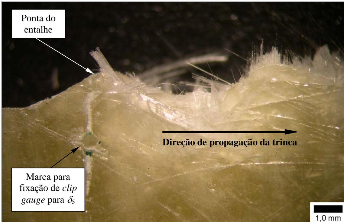
Figura 4.12 – Perfil de fratura do material MC1, corpo de prova C.
