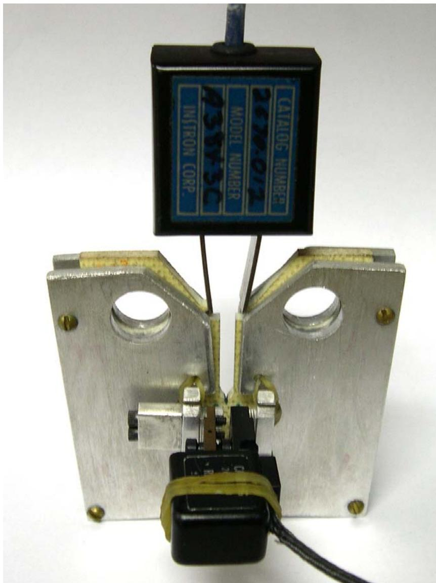
Figura 3.25 – Montagem dos corpos de prova do tipo C(T).
