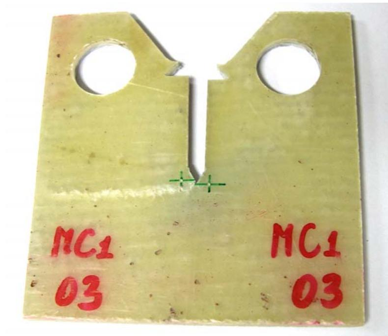
Figura 3.12 – Trinca propagada na direção das fibras no corpo de prova C(T) do material MC1.
