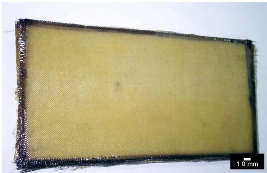
Figura 3.7 – Placa do Material Compósito (MC4) do Laboratório de Materiais Compósitos [59].
