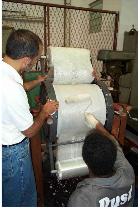
Figura 3.1 – Aplicação do material MC1 da empresa Rust Engenharia Ltda. sobre um segmento de duto [59].
