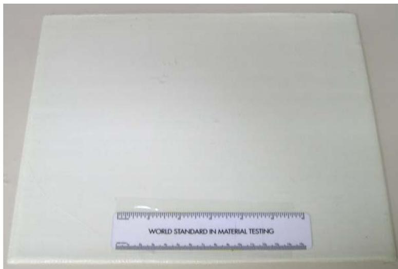
Figura 3.6 – Placa do material MC3 utilizada para a confecção dos corpos de prova.
