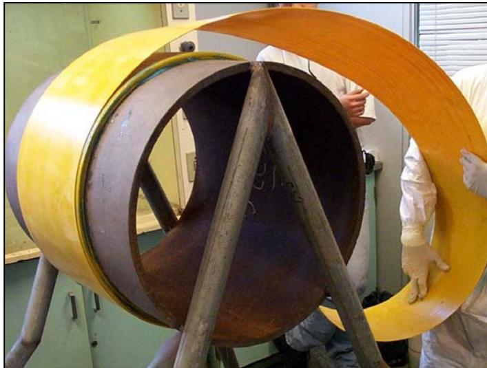
Figura 3.3 – Exemplo de aplicação do material MC2 da empresa Clock Spring® sobre um segmento de duto [29].
