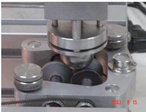
**Figura 16** : fotografia da esfera metálica sobre as roldanas na máquina de desgaste.
