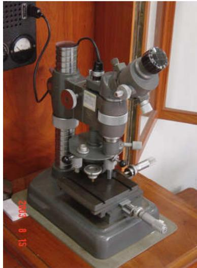
**Figura 14:** Fotografia do durômetro utilizado para determinação da dureza Vickers.
