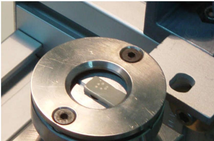
**Figura 17:** fotografia do corpo de prova fixado na máquina de desgaste, mostrando as crateras formadas.
