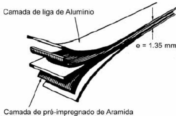
Figura 2.1 - Desenho esquemático de um FML Arall com empilhamento 3/2 (RITCHIE, *at al.*, 1989).
