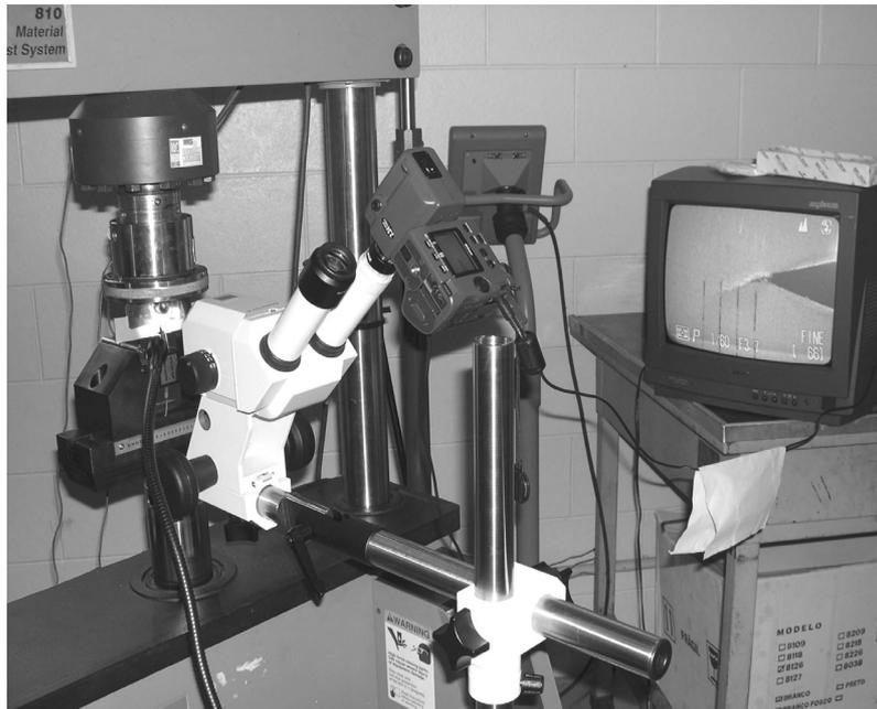
*Figura 3.7 – Instrumentação geral do ensaio do laminado Glare, com aquisição digital (microscópio e câmera) para acompanhamento do crescimento da trinca.*
