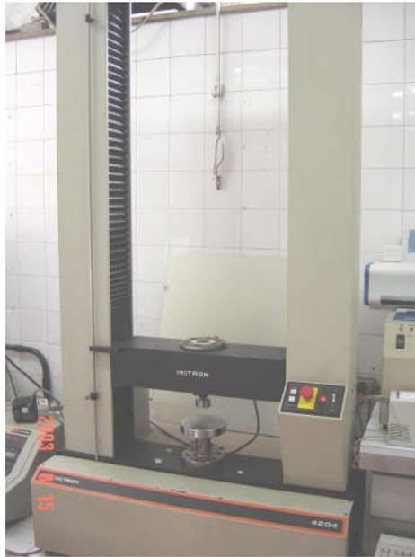
**Figura 18: Máquina INSTRON (4204) utilizada para o teste de Compressão e Flexão.**
