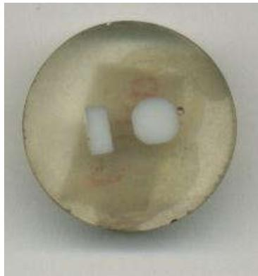
**Figura 15: Corpo de prova incluído para análise da microestrutura.**
