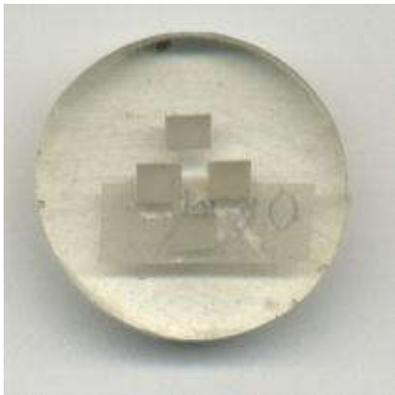
Figura 22: CPs incluídos para o teste de dureza Vickers.
