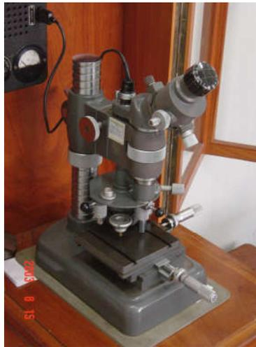
**Figura 23: Fotografia do durômetro utilizado para determinação da dureza Vickers.**
