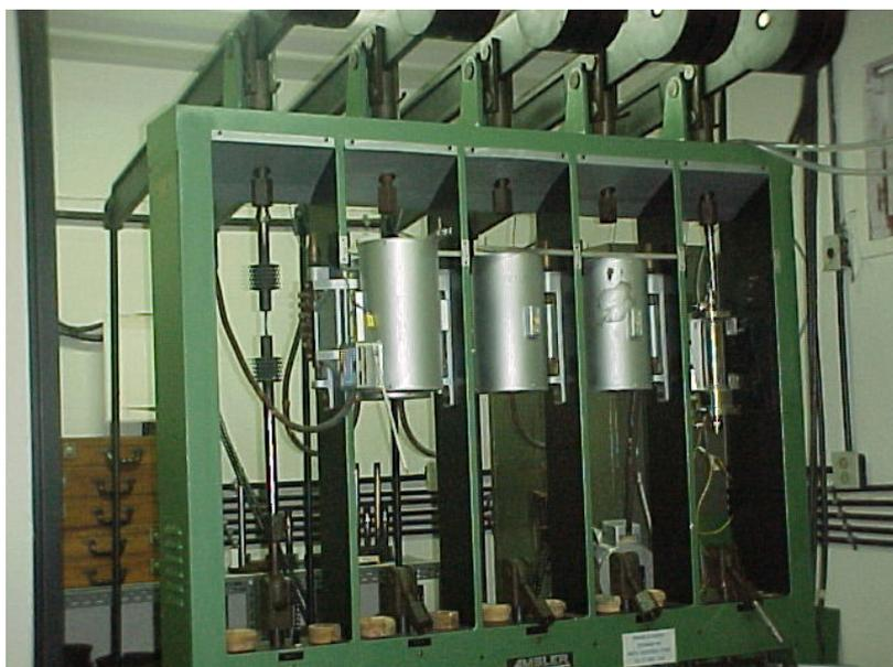
**Figura III.6 – Esquema de montagem dos corpos de prova na máquina de fluência**
