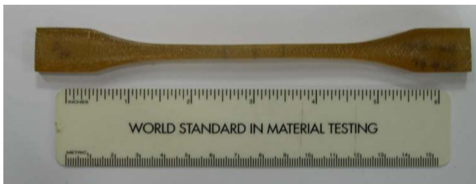
Figura 31 – Fotografia de um corpo de prova de resina polimérica produzido por moldagem.
