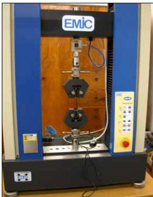
Figura 3.6 – Máquina de ensaio de tração utilizada - EMIC DL 10000.
