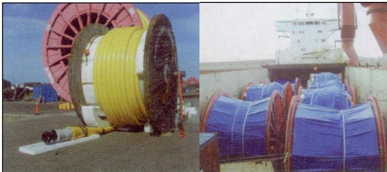
Figura 2.3 - Carretel típico de armazenamento de *risers* flexíveis (Souza, 2002).
