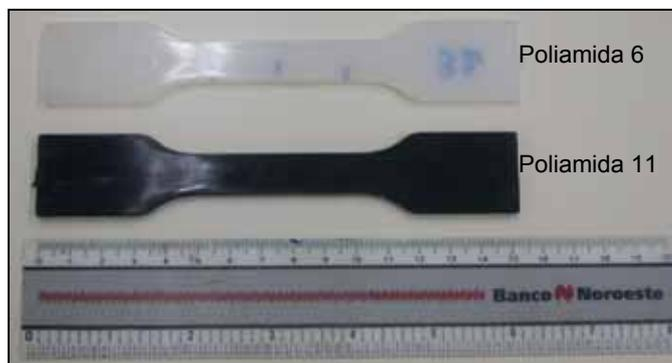
Figura 3.5 - Fotografia dos corpos de prova injetados pela empresa Mazzaferro.
