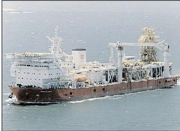
Figura 2.4 - Embarcação usada no lançamento de *risers* flexíveis (Marco, 2002).
