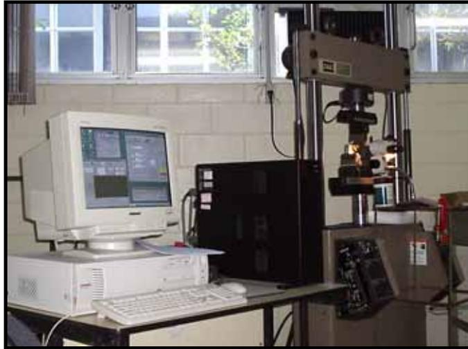
Figura 3.2 – Equipamento utilizado para os ensaios de fadiga.
