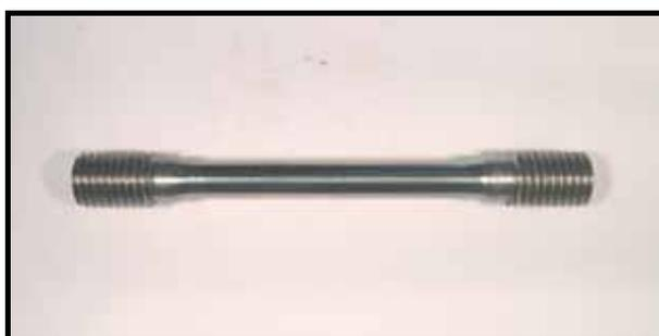
Figura 3.1 – Corpo-de-prova utilizado para os ensaios de tração.
