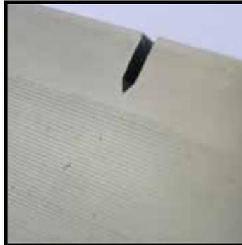
Figura 3.5 – Intervalos de comprimento para medição da propagação da trinca.
