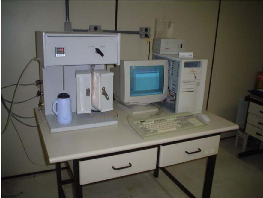
Figura 3.1: Unidade de multipropósito acoplada a um detector de condutividade térmica.
