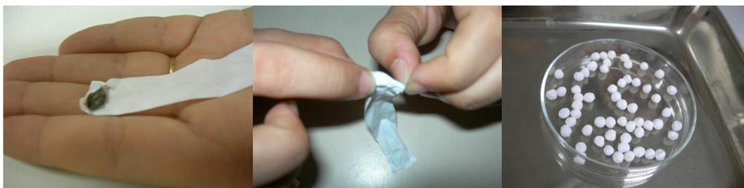
Figura 3.1. Partículas de clínquer revestidas com Teflon<sup>®</sup>.
