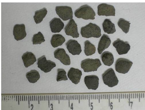
Figura 3.4. Imagem das partículas de uma das alíquotas do clínquer A.
