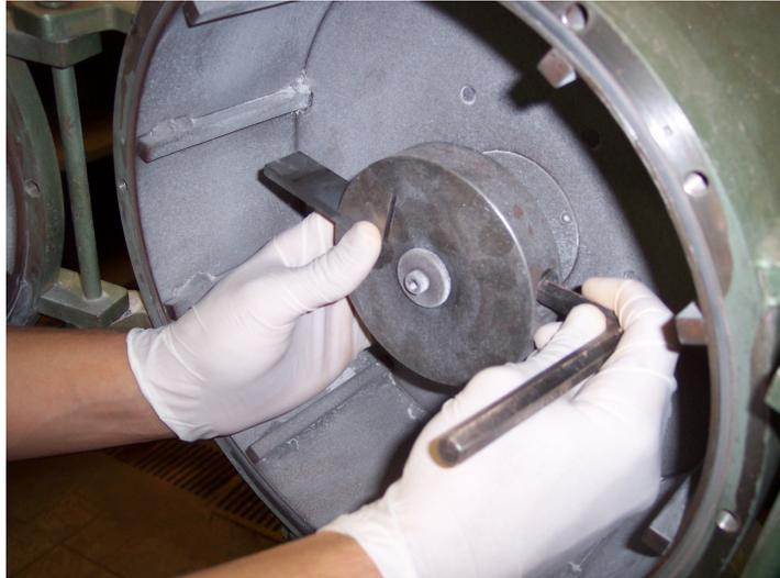
Figura 3.15. Detalhe do posicionamento da palheta no rotor.
