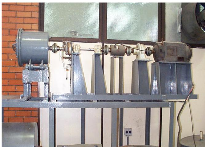
Figura 3.9. Moinho de bolas para ensaios de moagem descontínua.
