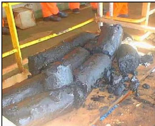
**Figura 2.** Depósito de parafina retirado de tubulações [2].
