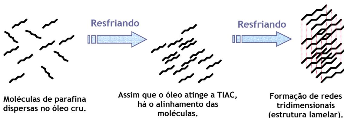
**Figura 5.** Esquema de formação de núcleos de parafina.
