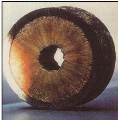
**Figura 1.** Vista de corte de um duto obstruído [1].
