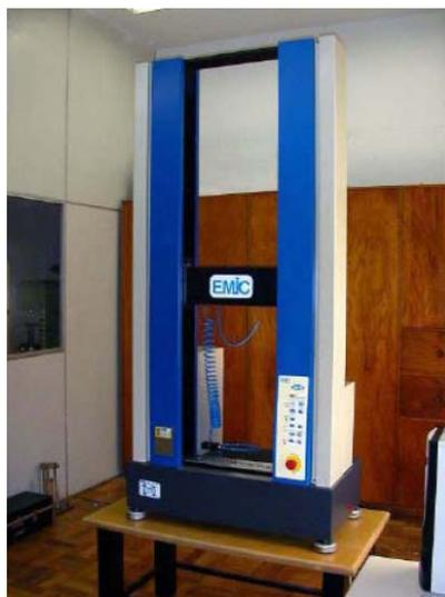
Figura 30 - Máquina EMIC onde foram realizados os ensaios de Resistência à Compressão Diametral.
