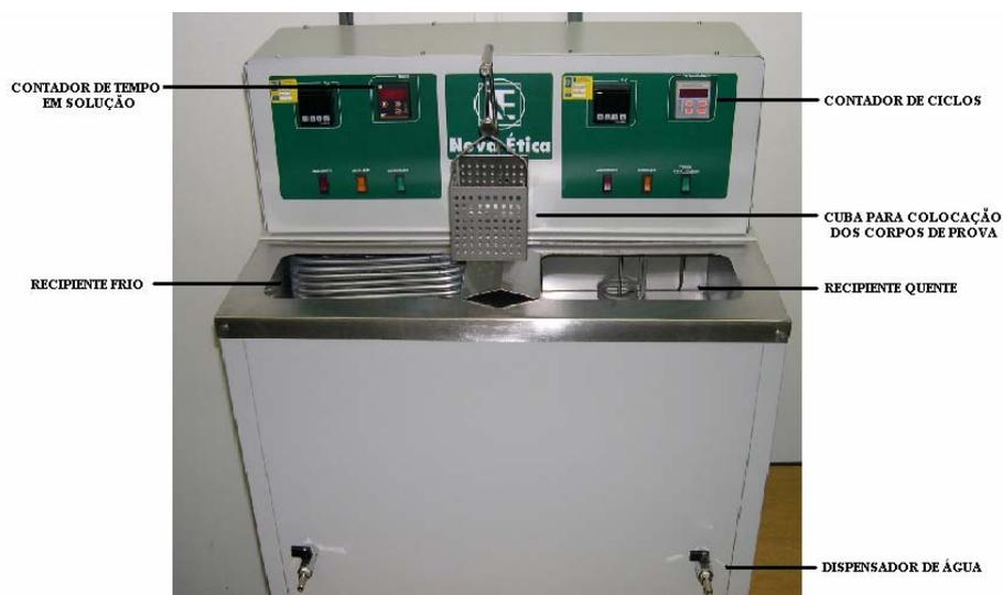
Figura 23 - Fotografia da máquina utilizada para ciclagem térmica dos corpos de prova.
