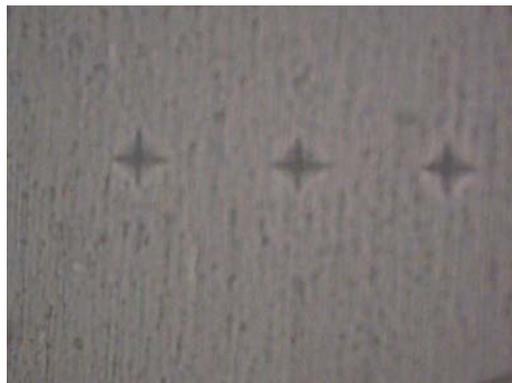
Figura 40 - Indentação observada no MO (200x) após ensaio de microdureza Vickers realizado no compósito Artglass<sup>®</sup> antes da ciclagem térmica.
