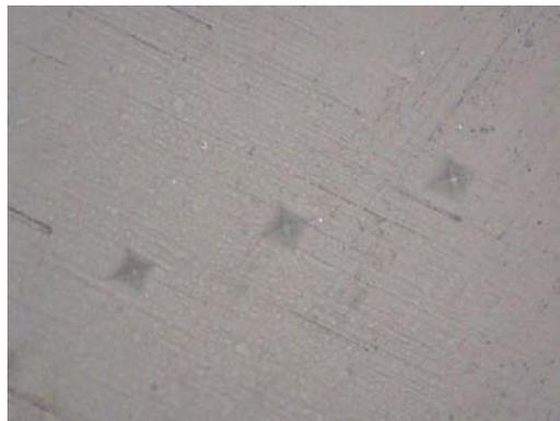
Figura 39 - Indentação observada no MO (200x) após ensaio de microdureza Vickers realizado no compósito Z350<sup>®</sup> após ciclagem térmica.
