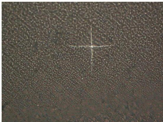
Figura 37 - Indentação observada no MO (500x) após ensaio de microdureza Vickers realizado no compósito *TPH 3*<sup>®</sup> após ciclagem térmica.
