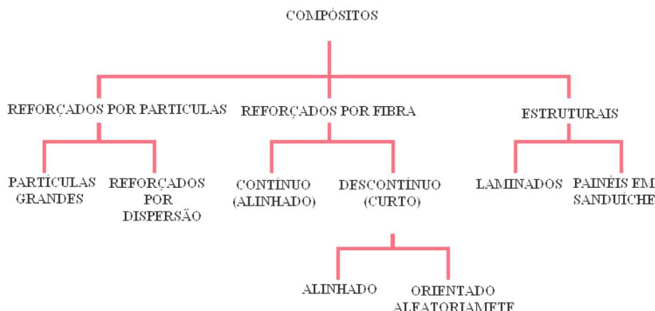
Figura 2 - Esquema para classificação dos vários tipos de compósitos (CALISTER JR., 2002).
