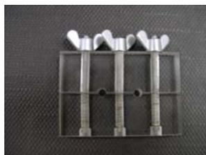
Figura 25 - Moldes para confecção de corpos de prova para os ensaios de compressão diametral (3 mm x 6 mm).
