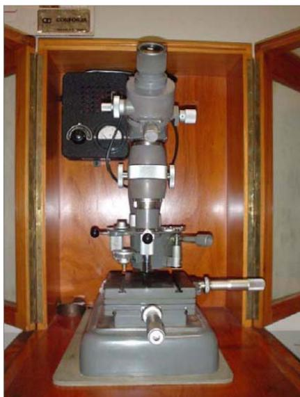
Figura 28 - Microdurômetro Vickers.
