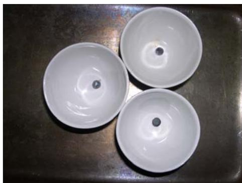
Figura 59 - Imagem dos corpos de prova após queima a 400° C.
