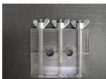
Figura 24 - Molde para confecção de corpos de prova para os ensaios de dureza (7 mm x 5 mm).
