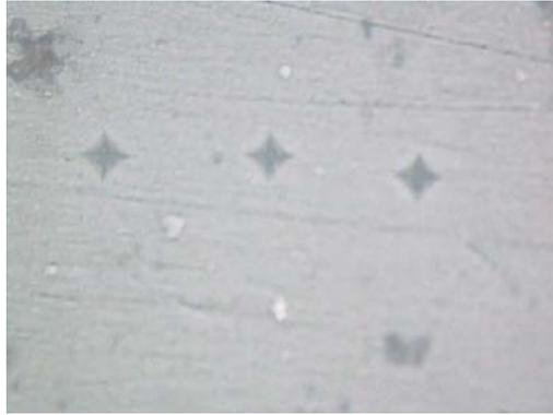
Figura 38 - Indentação observada no MO (200x) após ensaio de microdureza Vickers realizado no compósito Z350<sup>®</sup> antes da ciclagem térmica.
